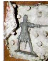
заливается олово или смола, олово легко плавится на обычной печке. Когда заливка остывает и затвердеет, форма разнимается. Но можно делать солдатиков и только из пластики, они получаются достаточно прочные и легкие. В магазине нет солдатиков в
