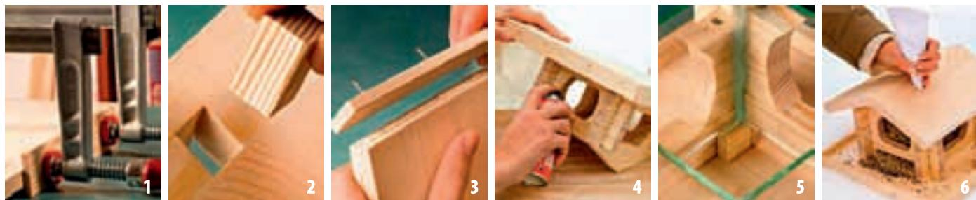
**1.** Ошкурьте или обработайте рубанком заготовки до гладкого состояния. Разметьте детали.
